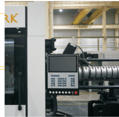
倍福控制系统 BECKHOFF control system
